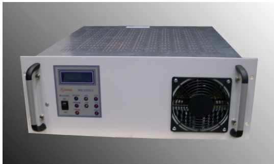
Wechselrichter 1,5kVA 110V DC 19" 4HE 460 mm tief IP20
